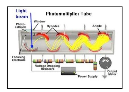
I fotomoltiplicatori devono essere schermati magneticamente in quanto, un campo magnetico esterno (anche quello terrestre), può deviare il percorso degli elettroni (particelle cariche) al suo interno.
