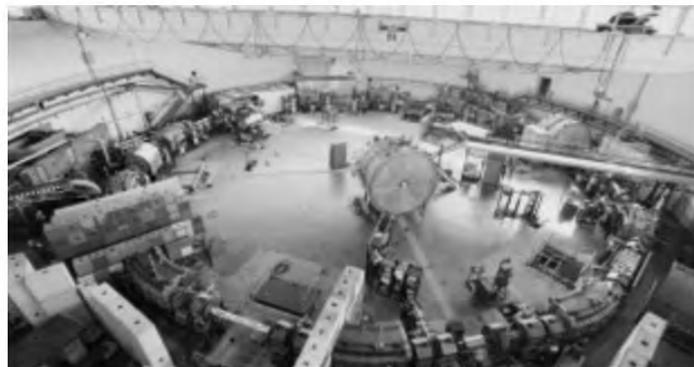
**ADONE (1969)**: fasci di elettroni e positroni, ciascuno di energia 1.5 GeV, circolavano in un anello lungo 105 m con quattro punti di interazione.
