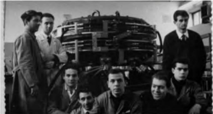
**AdA (1961)**: il primo acceleratore di particelle-antiparticelle (*collider*); costruito da Bruno Touschek; nello stesso anello elettroni e positroni circolavano in direzioni opposte con eguale velocità, annichilandosi e trasformando tutta l'energia iniziale in nuove particelle.
